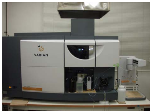
誘導結合プラズマ発光分光分析装置
