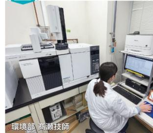
ガスクロマトグラフ(GC)で分離された成分をイオン化し、質量分析計(MS/MS)で検出します。
