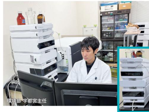
まずLCを用いて試料成分を相互分離し、その後、MS/MS定性・定量を行います。飲料水中の農薬をはじめ、その他多くの有害物質の検査のほか、環境検査(河川水、海水、土壌)や食品検査でも使用します。
